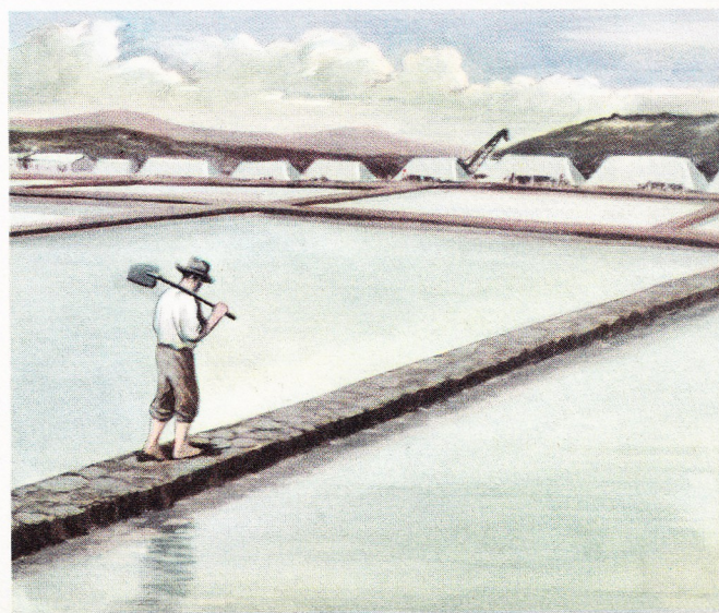
L'eau de mer, amenée dans ces bassins par un canal régulateur, en s'évaporant lentement, dépose une couche de sel qui, une fois les eaux mères évacuées, sèche pendant plusieurs heures.
